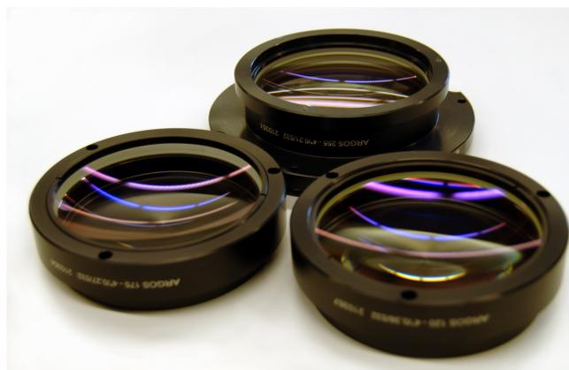
Abbildung 3.6.: Modulares Objektiv #2; Hauptmodul (oben) mit Schnittweite  $254,5 \text{ mm}$ ; Vorschraublinse #2.1 (links) für Schnittweite  $175,0 \text{ mm}$ ; Vorschraublinse #2.2 (rechts) für Schnittweite  $122,7 \text{ mm}$
