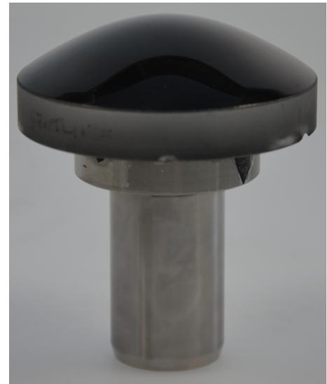
(b) Asphäre auf Befestigungsdorn für Spannfutter
